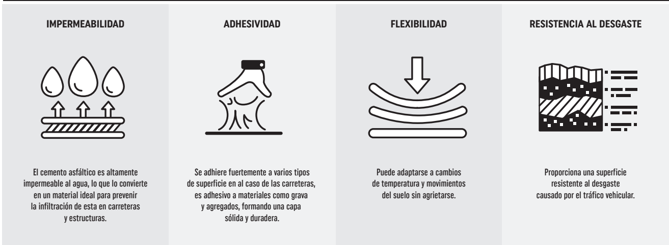
Figura 2. Propiedades generales del cemento asfáltico.
