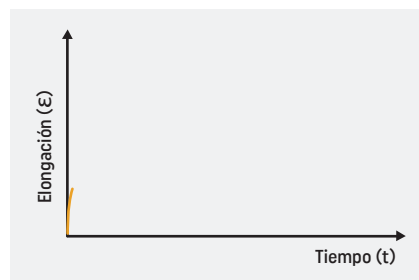
Figura 2.35. Respuesta inicial bajo carga constante para el Modelo de Kelvin-Voigt.
