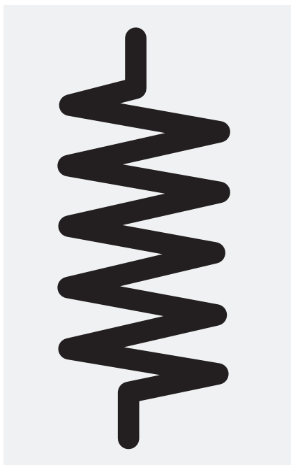
Figura 2.15. Representación del elemento elástico que sigue la ley de Hooke.
